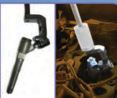
Dispositivos para retirar bico injetor eletrônico. Carretel Rosca M27 X 1mm. Sistema (sacador com rosca) em linha, ou individual no sistema (à percussão) Acompanha adaptador para Renault Master (apoiar na caixa seca do câmbio). OBS: Os bicos devem ser de rosca M27 X 1mm e estar sem o solenóide, em condições normais.
