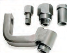
CR 377 Adaptadores para sacar bico injetor AMAROK 2012..., IVECO e outros com as mesmas características (extração pelo injetor lateral do bico que utilizam rosas: M12x1,5, M14 X 1,5mm e M17x1") Utilizar com CR 334 ou CR 26043 (martelo de impacto - rosca 1/2")
