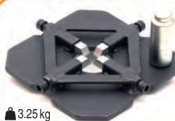
CR 104 Ferramenta c/ dispositivo ajustável para retirar a pista do rolamento do cubo de roda. Até Ø 60mm. (Usar com prensa hidráulica). 📦 3.25 kg
